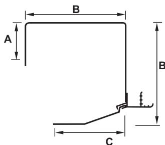
Der Putzkasten Punext aus Aluminium zeichnet sich durch seinen geringen Platzbedarf aus. Er liegt energiesparend unter dem Putz.
