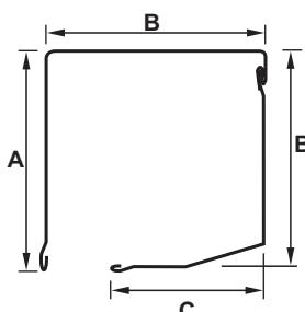
Der Eckkasten Varimax wird durch seine fünfeckige Form geprägt. Er passt sich jedem Baustil und jeder Fassade unauffällig an. Er wird vor das Fenster in die Laibung eingesetzt und schließt bündig mit der Hausfassade ab.
