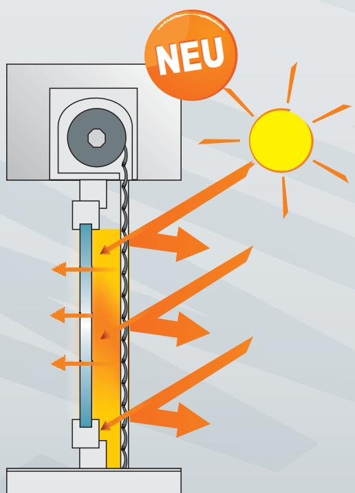
*UVR-Rollladen mit strahlungsreflektierender Rolladenrezeptur.*
