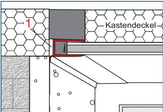
Beim Kastendeckelaustausch deckt die **Einfassleiste mit PCE-Dichtung** (1) und Dämmung den unschönen Spalt zwischen Kastendeckel und vorhandenem Putz sauber, dicht und zuverlässig ab.
