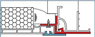
Wechselprofil + Klipsleiste
