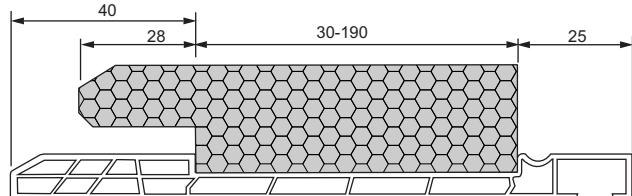
Rolladenkastendeckel Thermoflex N mit 25 mm Neopor u. Überstand
