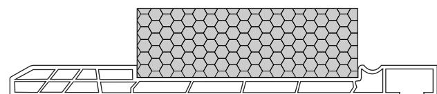
Rolladenkastendeckel Thermoflex N mit 22 mm Neopor, zusätzliche Traversendämmung notwendig (z.B. Dämmadapterprofil 3F)
